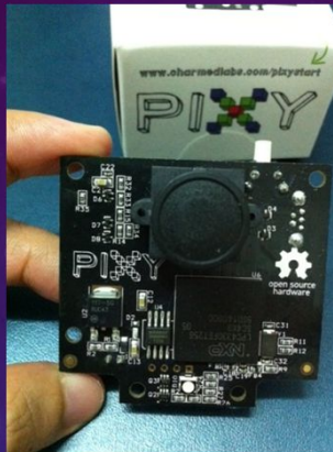
Pixy (CMUcam5) โมดูลกล้อง ตรวจจับสีและวัตถุ
