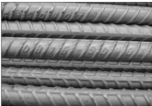
รูปภาพแสดงตัวพิมพ์บนผิวเหล็กข้ออ้อยระบุว่าเป็น DB16 SD40
