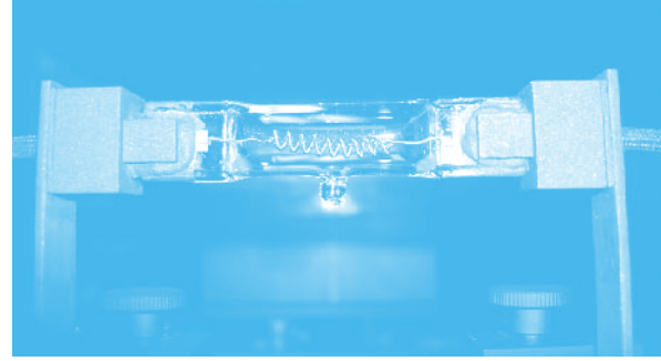
▲ รูปที่ 5 หลอดมาตรฐานปฐมภูมิความเข้มแสงเชิงสเปกตรัมของ มว.
