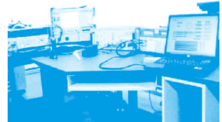
รูปที่ 6 ระบบการสอบเทียบแหล่งจ่ายกำลังไฟฟ้า
