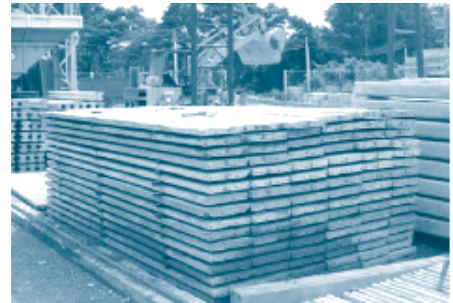
▲ รูปที่ 7 การจัดเก็บแผ่นพื้นที่ถูกต้อง
