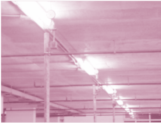
รูปที่ 3 การติดตั้งเสาอ้างอิงที่ใต้พื้นที่ทดสอบ และติดตั้งไดอัลเกจเพื่อใช้วัดระยะแอมตัวที่ท้องพื้น
