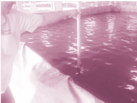
รูปที่ 4,5 การใช้ท่อน้ำพันเทปเพื่อกำหนดความสูงของระดับน้ำที่ขนาดน้ำหนักบรรทุกต่างๆ
