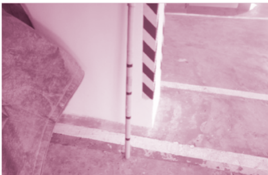
รูปที่ 3 การติดตั้งเสาอ้างอิงที่ใต้พื้นที่ทดสอบ และติดตั้งไดอัลเกจเพื่อใช้วัดระยะแอมตัวที่ท้องพื้น
