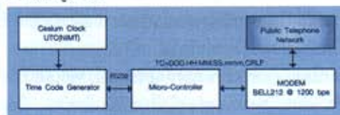
รูปที่ 3 Block Diagram แสดงการทำงานของ Transmitter Unit
