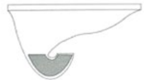
▲ รูปที่ 4 รูปตัดโถส้วมนั่งยอง แสดงตำแหน่งคอกห่าน
